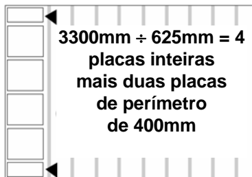
Os perfis T principais devem ser dispostos perpendicularmente à barra ou às vigas de madeira.
